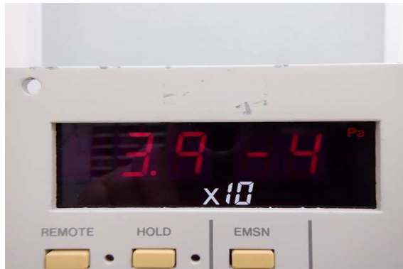
NORMAL点灯時の到達圧力: 3.9 \times 10^{-4} Pa
